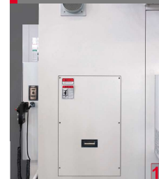
Right side service door
