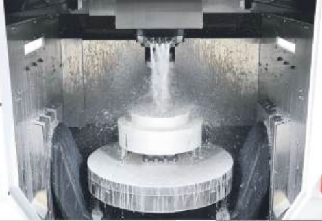
主軸外冷卻液系統
