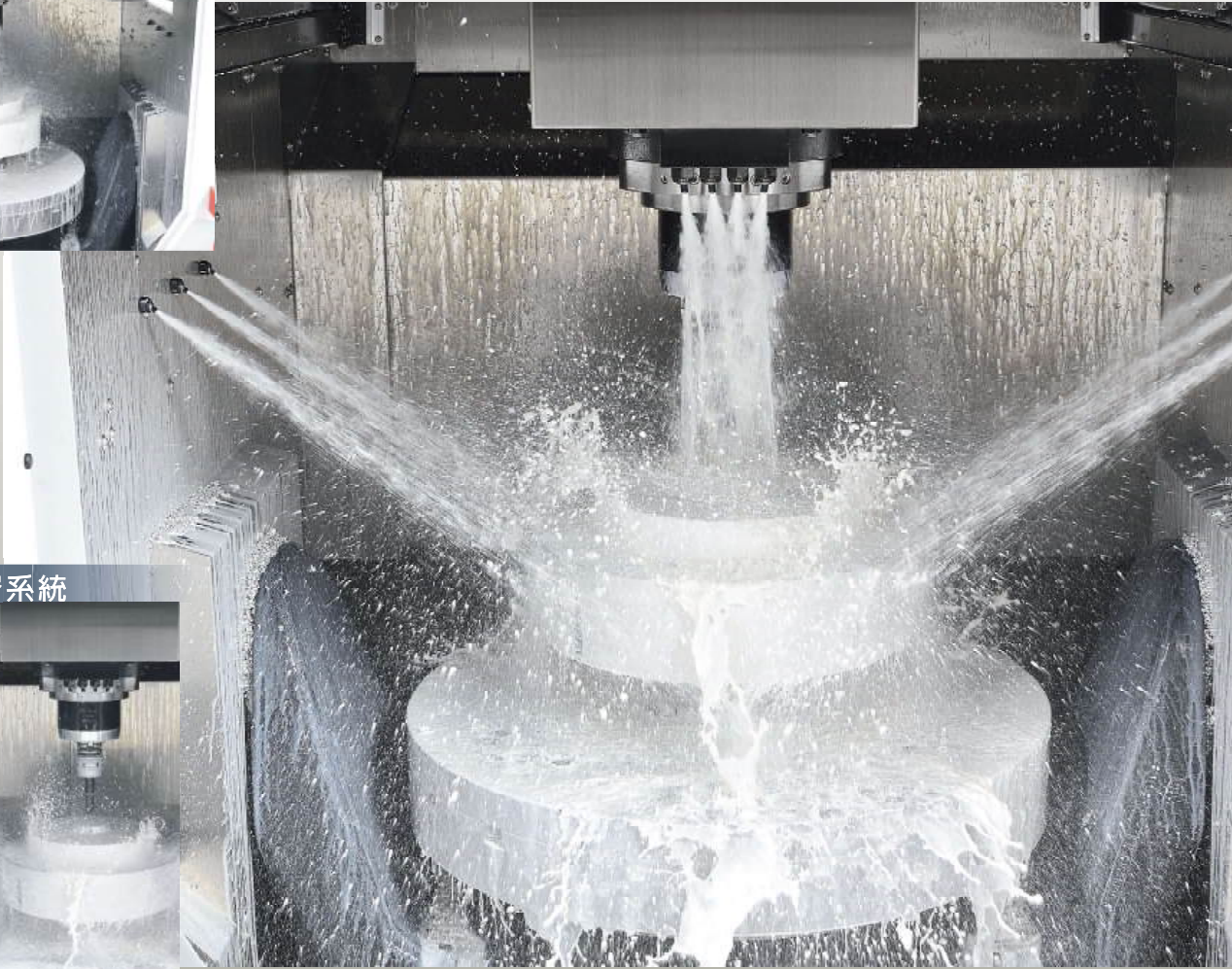
刀具/工件沖屑系統
