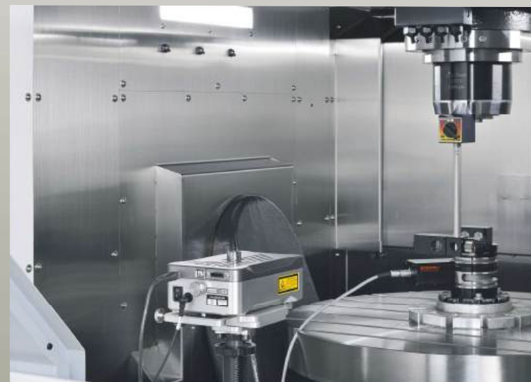
旋轉軸雷射精度檢測
