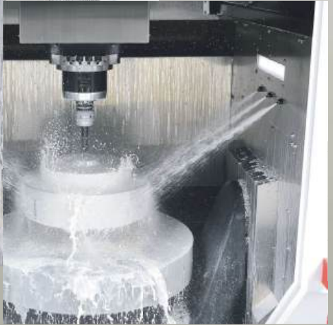
刀具/工件沖屑系統
