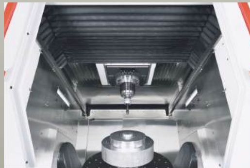
在光滑陡峭的不銹鋼內壁能有效引導切屑排出，沖屑系統能有效防止切屑堆積
