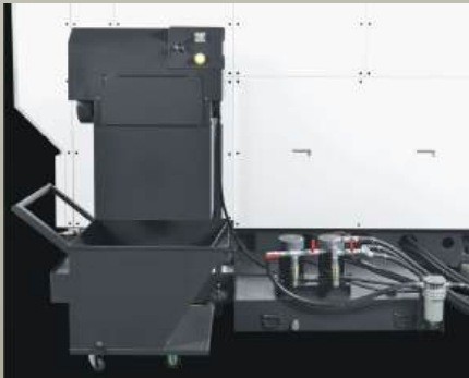
在光滑陡峭的不銹鋼內壁能有效引導切屑排出，沖屑系統能有效防止切屑堆積
