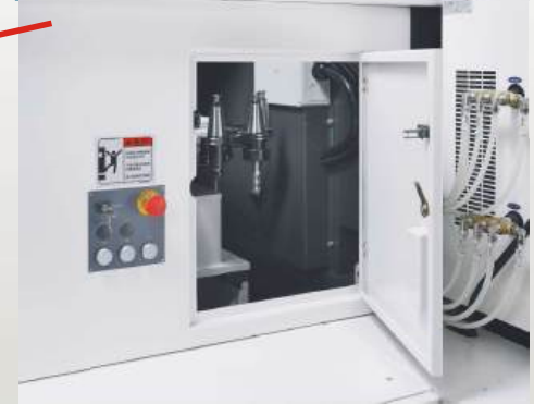
ATC maintenance door
