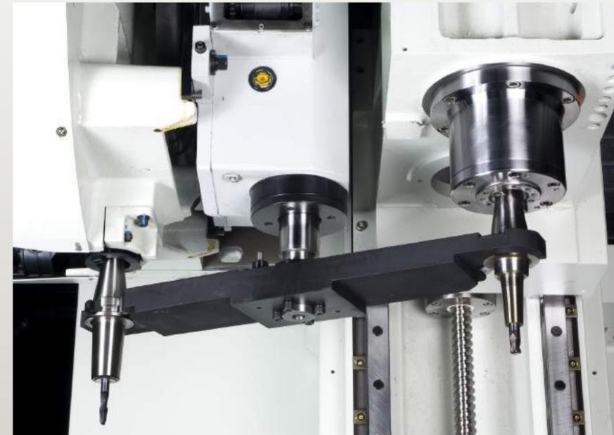
刀臂式換刀機構
